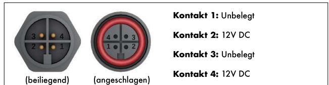
Abb.4: Kontaktbelegung des Motor-Steckverbinders
